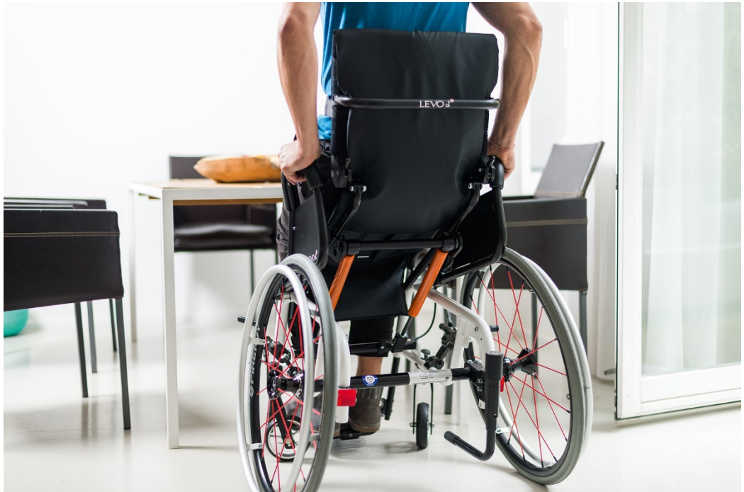
Bild 1: Die Stehrollstühle von Levo lassen sich dank der individuell ausgelegten Suspa-Gasfedern (im Bild orangefarben) leicht in die aufrechte Position bringen.
