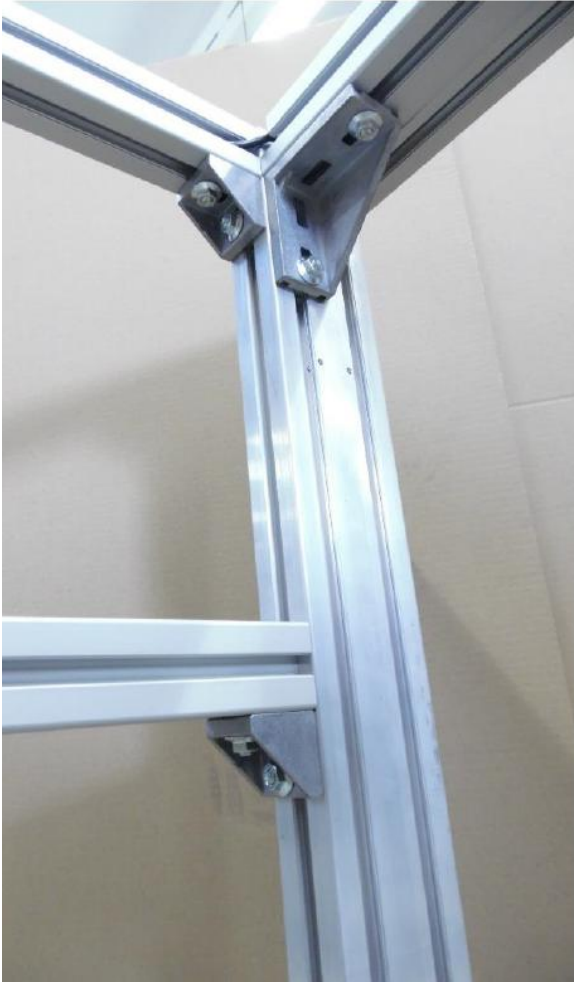
Abbildung 13: SMS-B-45x90: Beispiele zur Verbindung Hubelement mit Grundrahmen mittels handelsüblicher Anbindungswinkel (klein/groß)
