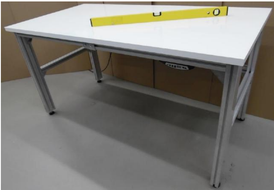
Abbildung 30: Einstellen des Arbeitsplatzes mit Wasserwaage
