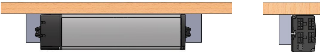
Abbildung 13: Anordnungen der Standard Steuerung SMS LTC384 (ohne Kippsensor)
