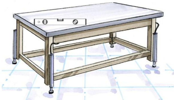
Abbildung 23: Einstellen des Arbeitsplatzes mit Wasserwaage
