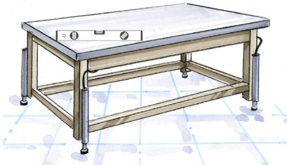
Abbildung 34: Einstellen des Arbeitsplatzes mit einer Wasserwaage
