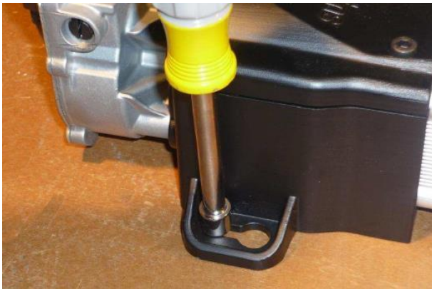
Abbildung 14: Montage der Befestigungselemente für die Motorhalterung
