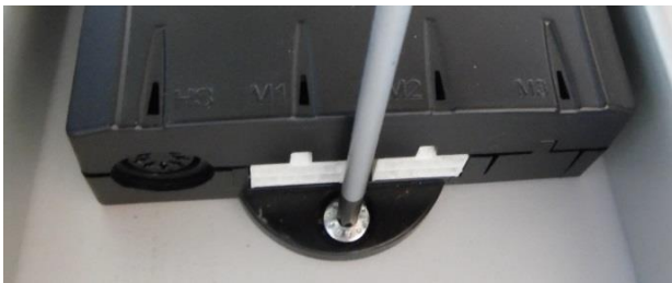
Abbildung 17: Befestigung der Motorsteuerung
