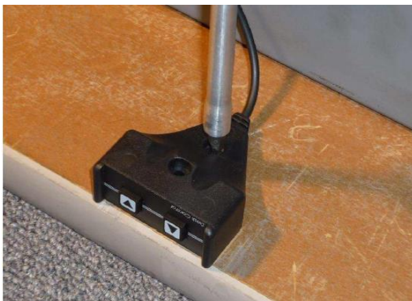
Abbildung 26: Markieren der Bohrungspositionen
