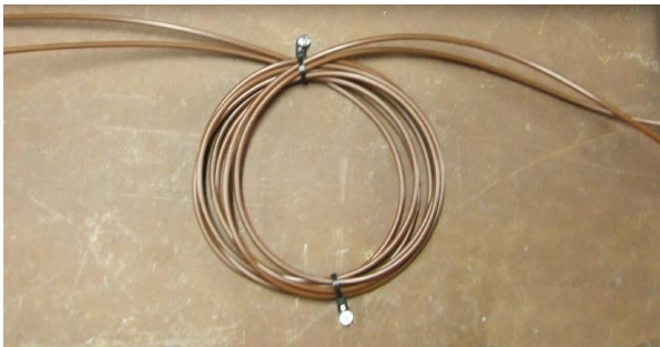
Abbildung 33: Aufwickeln von Hydraulikschläuchen
