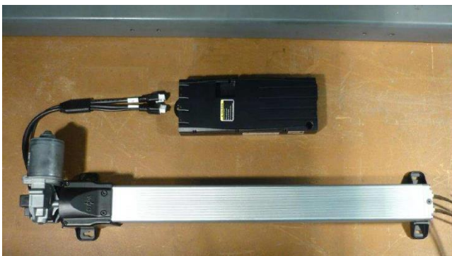
Abbildung 16: Anbringen der Motorsteuerung
