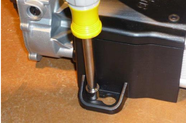
Abbildung 14: Montage der Befestigungselemente für die Motorhalterung
