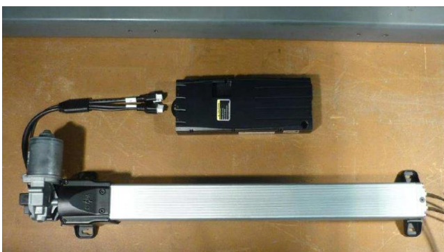
Abbildung 16: Anbringen der Motorsteuerung
